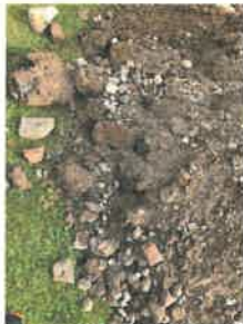
Figure 26 : Remblais présents à partir de -0,90 cm
